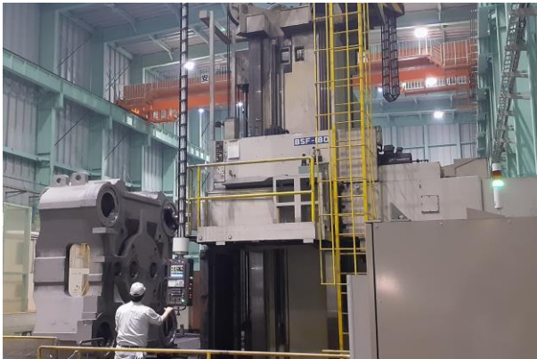
主軸φ180×長2600mm NC横型機 (耐荷重60トン・任意割出テーブル、 エクステ+ロングストロークで深穴加工可)
