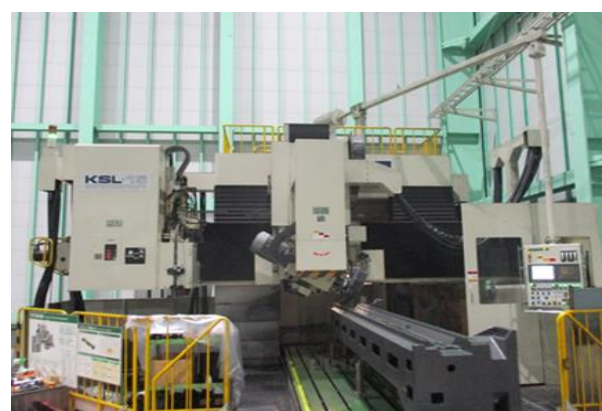
クラウニング研磨機 (部品の自重たわみを補正可)
