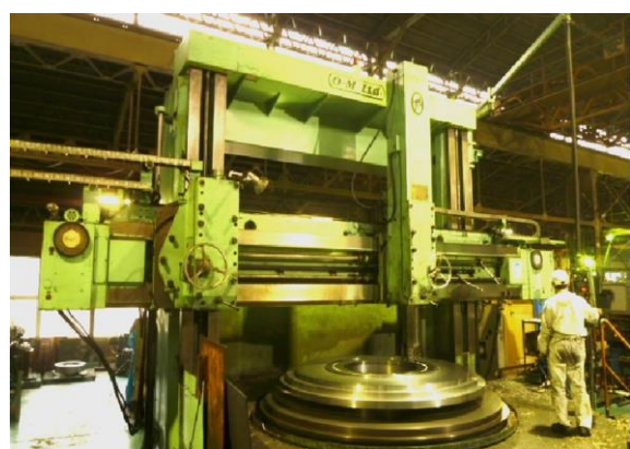
重電部品のターニング加工 (φ4000×H2800mmまで加工可)
