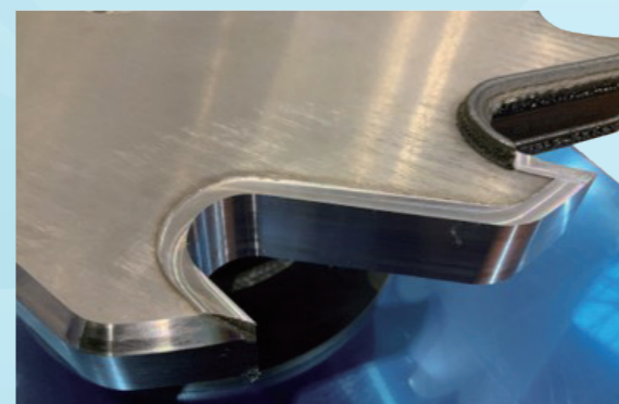
側面のみ補修した事例
